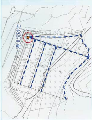
屏遮那平台土石堆置場排水規劃示意圖
