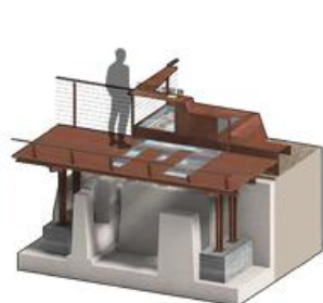
B 原木製材 (送材車/五呎機走道)
